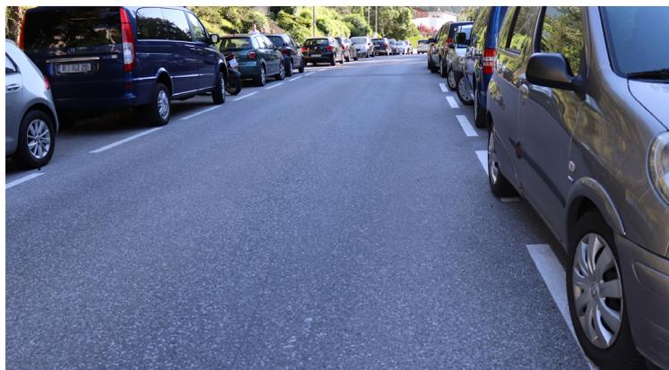
Die Markierungen sorgen für eine optische Fahrbahnverengung und sollen die Sicherheit erhöhen.
